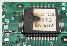
сгоревший процессор магнитолы
