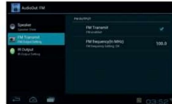
FM передатчик данного устройства может передавать беспроводной сигнал другому какому-либо устройству, поддерживающему FM диапазон, например, магнитоле.
