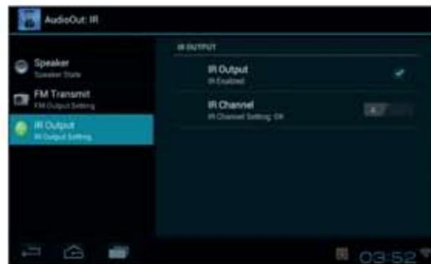
ИК передатчик может передавать аудио сигнал другому устройству с ИК приемником.
