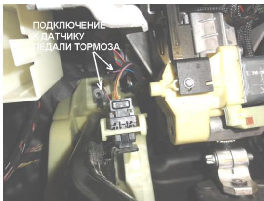
Рис. 3. Место подключения к датчику педали тормоза
