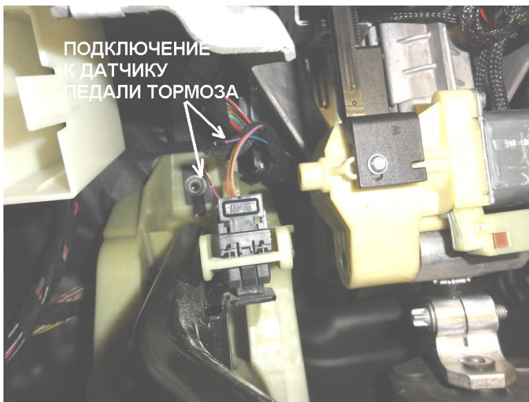
Рис. 3. Место подключения к датчику педали тормоза
