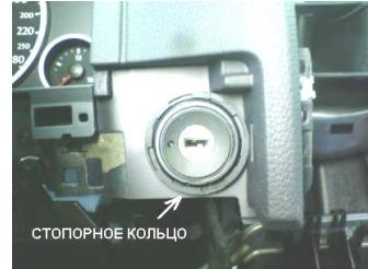
6. Для работы обходчика иммобилайзера необходимо подключиться к рамке считывателя. Для этого открутите два винта с лицевой стороны блока замка. С помощью отвертки расщелкните защелки по периметру корпуса блока замка, и снимите корпус. Подпайте разъем обходчика к указанным точкам.
