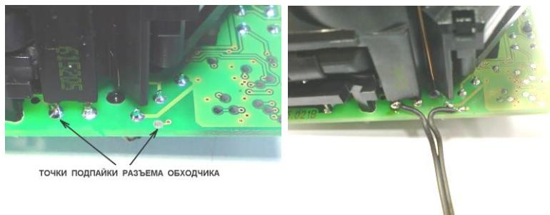
7. Сделайте разрез токоведущей дорожки на плате, а также вырез в корпусе блока замка под провод обходчика как показано ниже.
