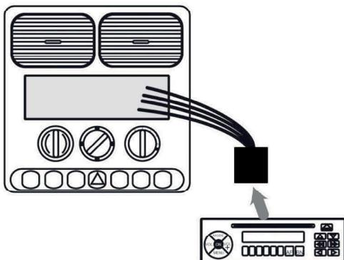
2. Подсоедините провод рулевого управления к новому головному устройству.
