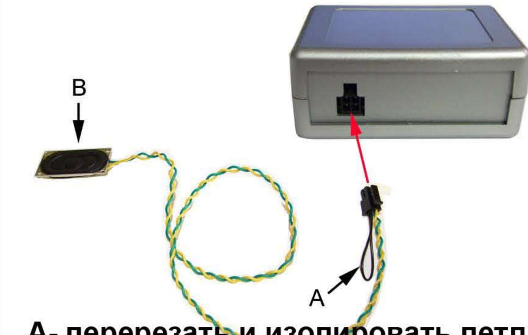
**A**- перерезать и изолировать петлю (авто с 4-х строчным оригинальн. дисплеем)
